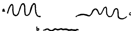
(a) Respuesta normal; (b) Efectos del veneno; (c) El metal envenenado, restablecido por el antídoto.
